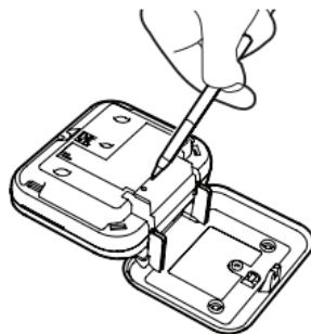
2. Pendant ces cinq secondes, il faut appuyer brièvement sur le bouton de test du détecteur 1 pour relier les deux détecteurs sans fil. Le détecteur 1 émet deux séries de trois bips sonores.
