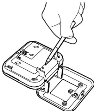
2. Drücken Sie innerhalb dieser fünf Sekunden kurz auf den Testknopf von Melder 1, um die Funkverbindung zwischen den beiden Meldern herzustellen. Melder 1 wird zwei Alarmsequenzen von jeweils drei lauten Pieptönen abgeben.
