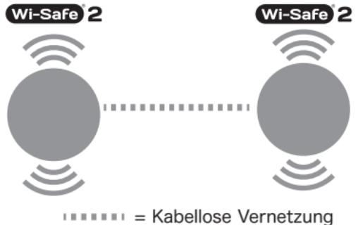
Die Wi-Safe-2-Technologie ermöglicht die Funkvernetzung mit anderen Wi-Safe-2 Meldern. Wenn ein Melder Kohlenmonoxid detektiert, sendet das Modul ein Hochfrequenzsignal an alle verbundenen Melder, wodurch eine flächendeckende Alarmierung im Netzwerk erfolgt.
